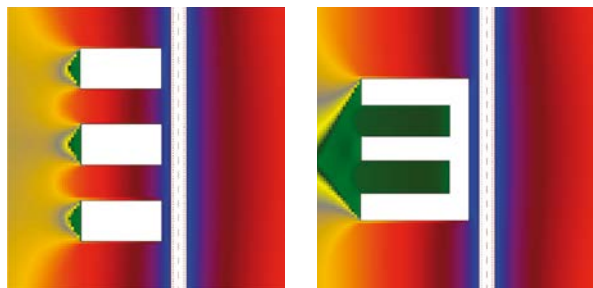
Abbildung 46: Alternative Anordnung von Gebäuden an einer Straße, Grundrisse und Lärmbelastung; links: offene Querriegel, rechts: Abschirmung durch Längsriegel.
