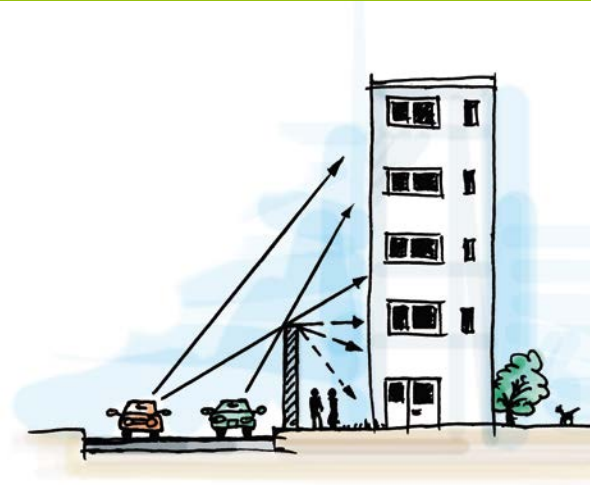
Abbildung 29: Der untere Bereich hinter der Lärmschutzwand ist geschützt, nach oben hin nimmt die pegelmindernde Wirkung ab; der obere Bereich mit Sichtverbindung hat keinen Schutz
